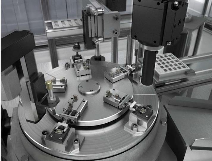
Permette di eseguire un'ispezione dettagliata della qualità degli oscillatori al quarzo ignorando l'influenza della texture e le singole differenze tra target.
