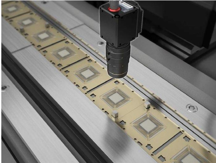
Assicura la qualità del rivestimento rilevando variazioni anche minime di colore o spellature, anche su linee di produzione ad alta velocità.
