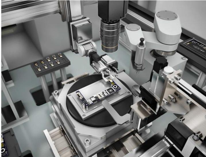
Consente l'allineamento estremamente accurato e ad alta velocità dei moduli della telecamera.
