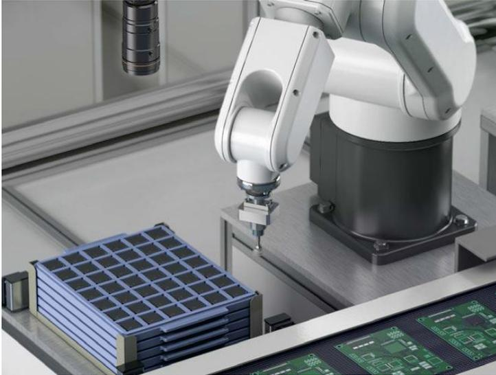
Esegue la guida robotizzata per prelevare i chip. La connessione semplice e diretta con i robot di vari produttori permette di ridurre drasticamente le ore di manodopera richieste per l'avvio.
