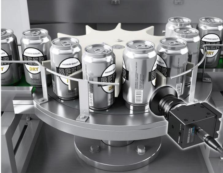
Data la presenza di stampe, spesso risultava difficile eseguire ispezioni per individuare difetti come ammaccature delle lattine. Con una telecamera lineare è possibile rimuovere la stampa ed estrarre solo ammaccature e macchie.
