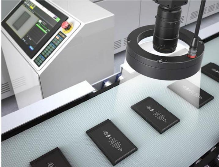
Esegue l'ispezione di macchie e ammaccature formatesi sulla superficie delle batterie. La Luce Multidirezionale rileva solo la variazione in altezza di difetti come ammaccature o protuberanze, ignorando informazioni 2D incluso lo sfondo stampato.
